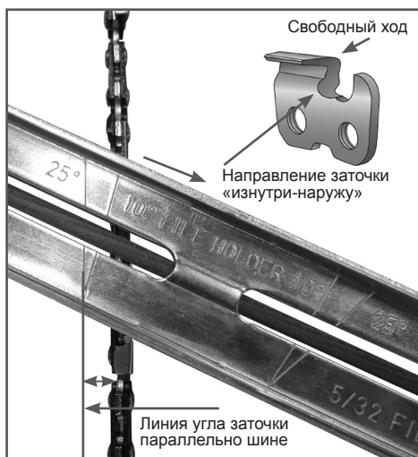
Рис. 21 Линии углов заточки цепи
