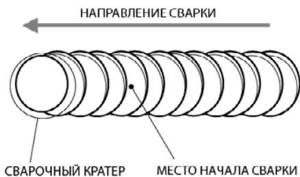
Рис. 9.4. Начало сварки при смене электрода.
