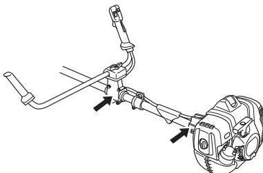
Неправильно закрепленная леска или незаточенное, неправильное режущее оборудование (не соответствующий тип или неправильно заточенные, см. раздел Затачивание лезвия) способствуют увеличению вибрации.
