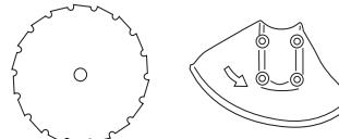
Лезвие и нож для травы предназначены для выкапывания сильной травы.
