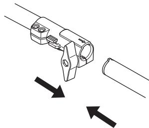
Перед использованием узла, хорошо затяните ручку.
