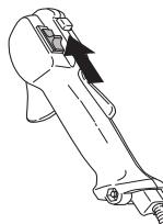
**ВНИМАНИЕ!** Контакт остановки автоматически возвращается в положение запуска. Во избежание непроизвольного запуска, колпачок зажигания следует всегда снимать со свечи зажигания при монтаже, проверке и/или обслуживании.
