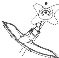
При сборке надо затягивать гайку против направления вращения режущего оборудования. При разборке надо отвинчивать гайку в направлении вращения режущего оборудования.
