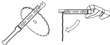
Проверьте режущее оборудование на наличие повреждений или трещин. Поврежденное режущее оборудование следует обязательно заменить.
