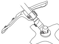
Проверьте, чтобы защита не была повреждена и чтобы на ней не было трещин. Замените защиту, если она была подвержена удару или если на ней есть трещины.
