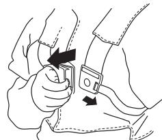
Удостоверьтесь, что привязные ремни оснастки были правильно расположены. Когда машина будет отрегулирована, проверьте работу системы быстрого отстегивания оснастки.
