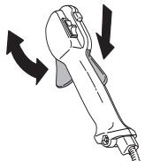
См. указания в разделе Запуск. Включите машину и полностью откройте дроссель. Отпустите рычаг дросселя и удостоверьтесь, что режущее оборудование останавливается и остается неподвижным. Если после постановки дросселя в положение холостого хода режущие оборудование продолжает вращаться, следует проверить регулировку холостого хода
